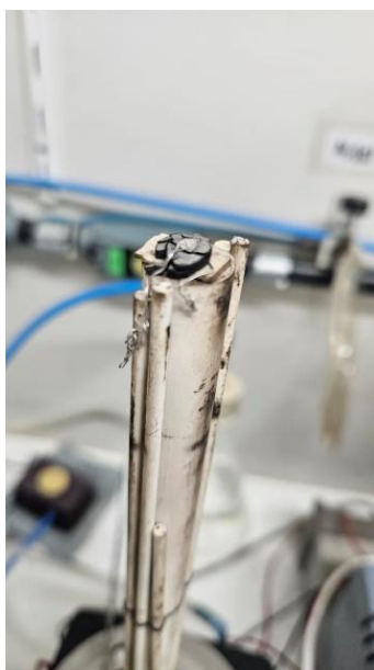
Figura 6.23 - Amostra de BCFZY900s degradada após ensaio em atmosfera de hidrogênio seco (900°C) com fluxo de 50 SmL/min
