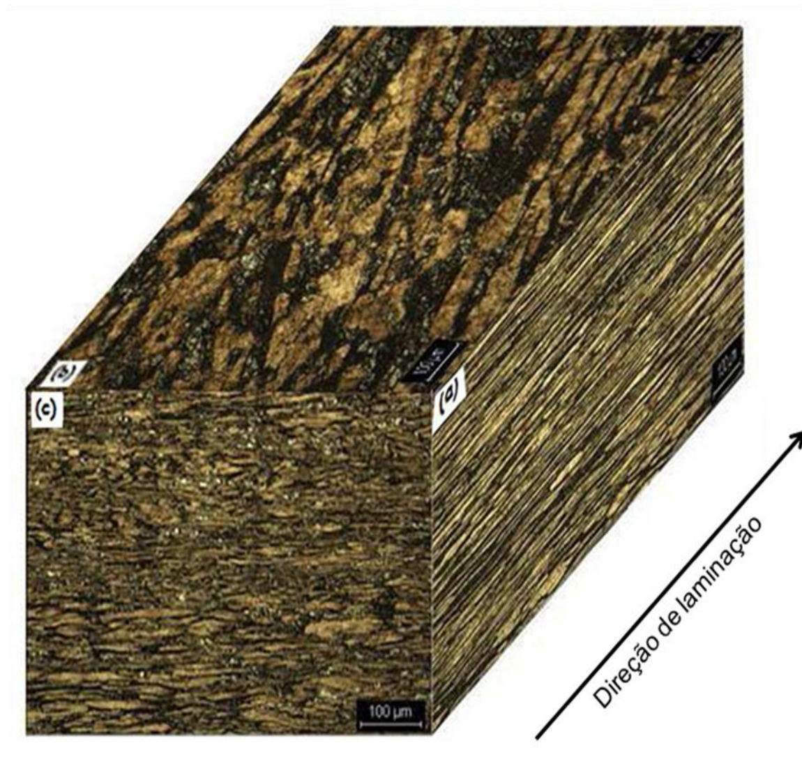
Figura 32 - Apresentação tridimensional da microestrutura do aço inoxidável dúplex, como recebido, nas direções: (a) longitudinal, (b) superior e (c) transversal. Região clara: austenita. Região escura: matriz ferrítica.
