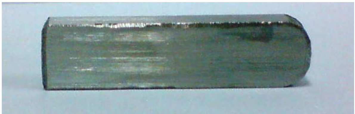
Figura 27 - Modelo dos corpos de prova utilizado na extrusão.
