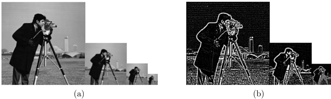
Figura 3.5 – (a) Pirâmide passa-baixa (Gaussiana) (b) Pirâmide passa-banda (Laplaciana)
