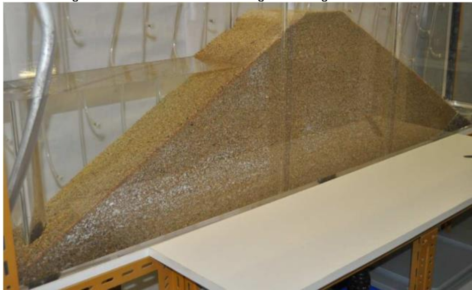
Figura 9 – Modelo físico de barragem homogênea
