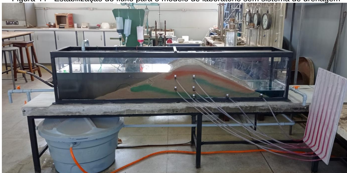
Figura 44 - Estabilização do fluxo para o modelo de laboratório sem sistema de drenagem
