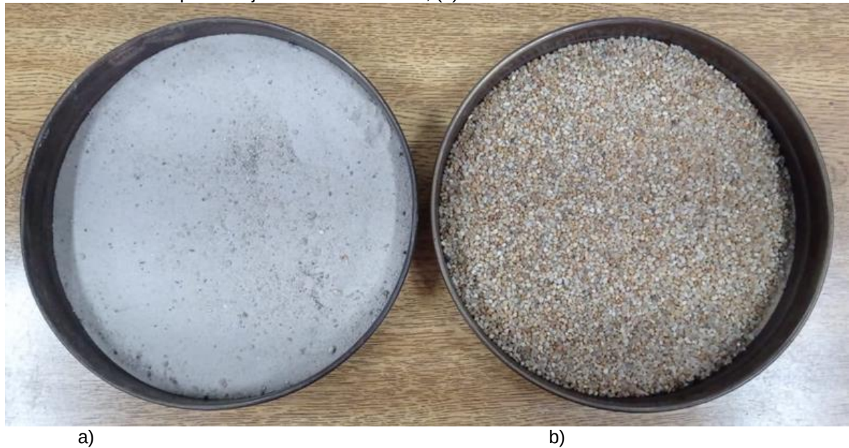
Figura 18- Areias utilizadas na construção dos modelos de barragem; (a) Material utilizado no espaldar a jusante e a montante, (b) Material utilizado como filtro
