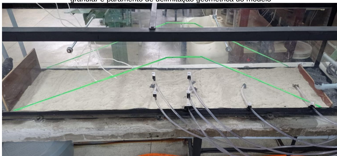
Figura 31– Construção do modelo de laboratório de barragem a partir da deposição do material granular e paramento de delimitação geométrica do modelo
