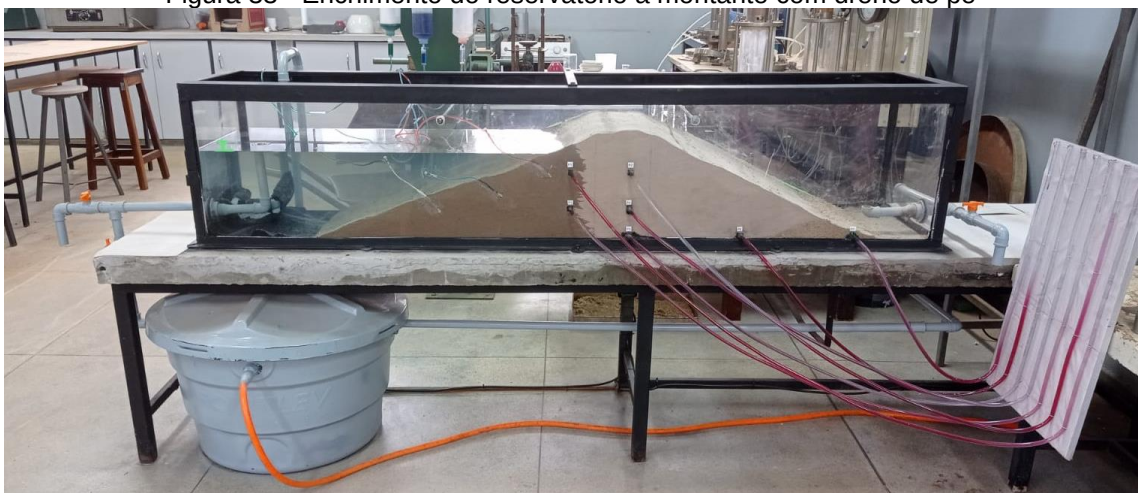
Figura 33 - Enchimento do reservatório à montante com dreno de pé
