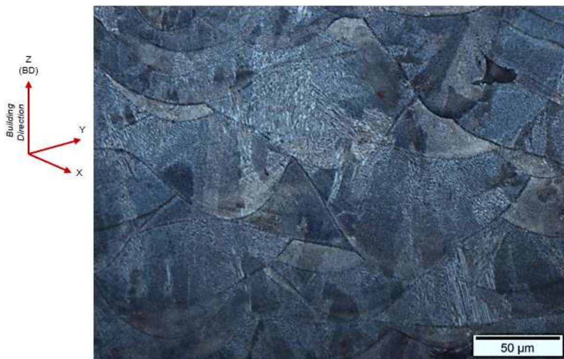
Figura 58 - Inconel 718 as built, lixado, polido e atacado observado por MO.
