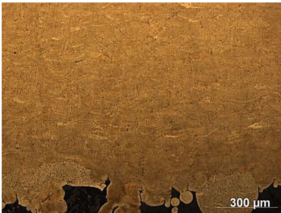
Figura 66 - Inconel 718, feito por PBF - LB, solubilizado, atacado com oxálico e observado por MO.
