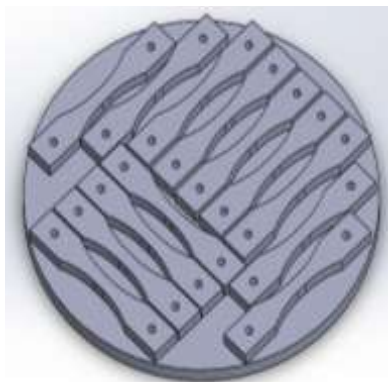
Figura 18 - Representação esquemática do corte de corpos de prova em uma barra com 3 mm de espessura.
