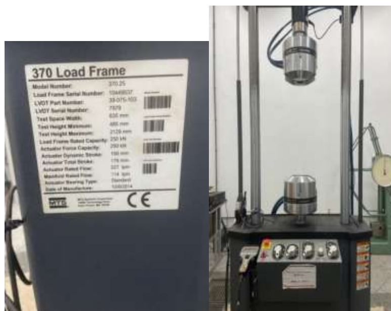
Figura 29 - Máquina de ensaios MTS 370.25
