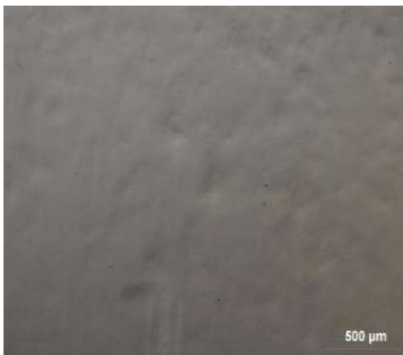
Figura 28 - Exemplo de imagem utilizada para obter a porcentagem de porosidade nas amostras de MA.
