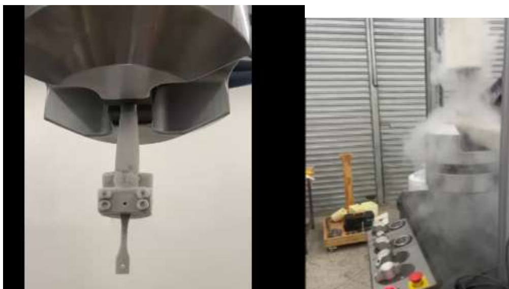
Figura 30 - Ensaio de tração criogênico.
