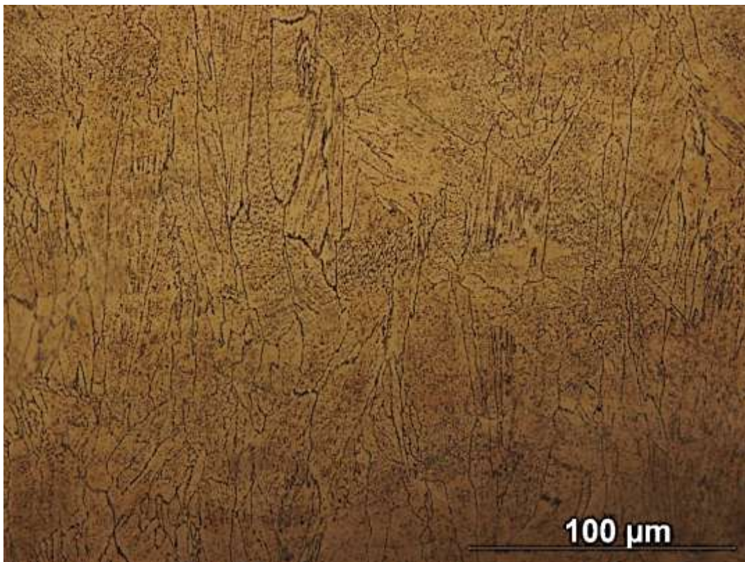
Figura 67 - Inconel 718, feito por PBF - LB, solubilizado, atacado com oxálico e observado por MO.
