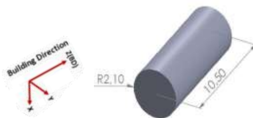
Figura 23 - Medidas dos cilindros utilizados para cálculo de densidade e porosidade.
