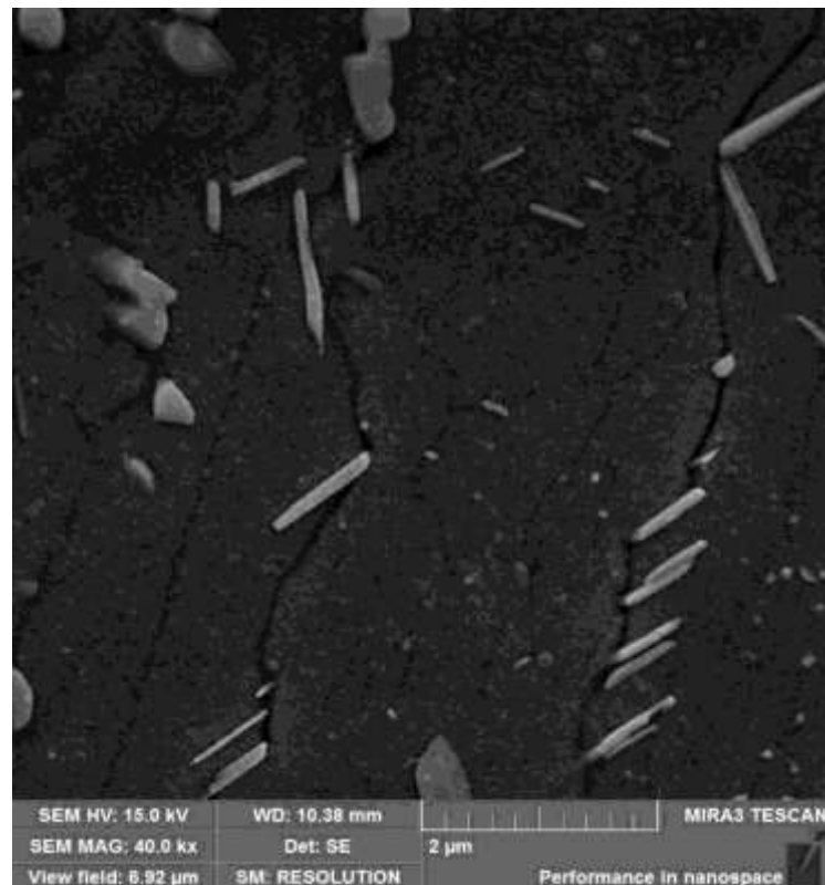
Figura 69 - Inconel 718, feito por PBF - LB, solubilizado, atacado com oxálico e observado por MEV.
