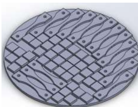
Figura 17 - Representação esquemática do corte de corpos de prova em uma barra com 2 mm de espessura.
