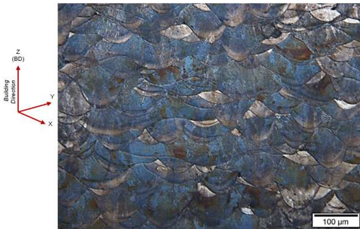
Figura 57 - Inconel 718 as built, lixado, polido e atacado, observado por MO.
