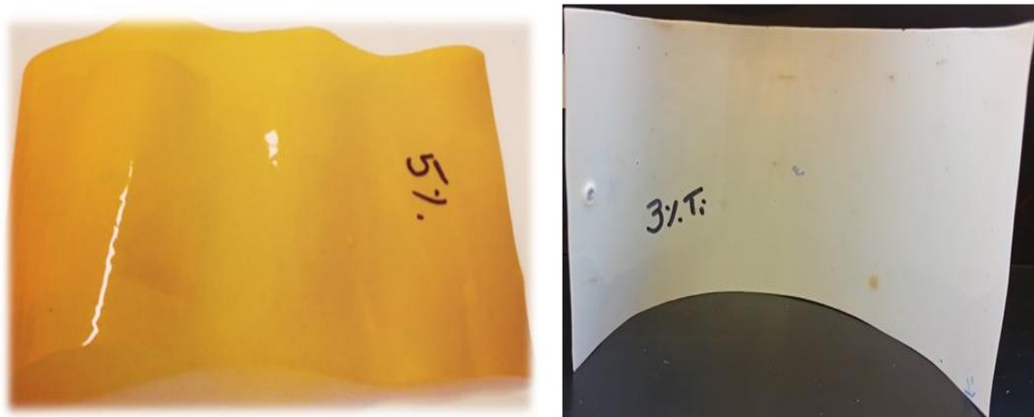
Figura 12 – Imagem da membrana modificada a partir dos filtros de cigarro com íons \text{Fe}^{3+} e Ti imobilizados
