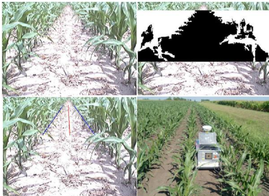
Figura 14 Funcionamento do processamento de imagens do robô.
