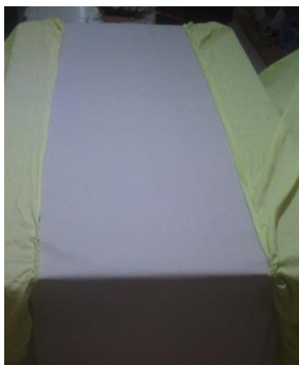
Figura 27. Mesa coberta com papel cinza, indicando o caminho do robô, e dois panos verdes, indicando as bordas.
