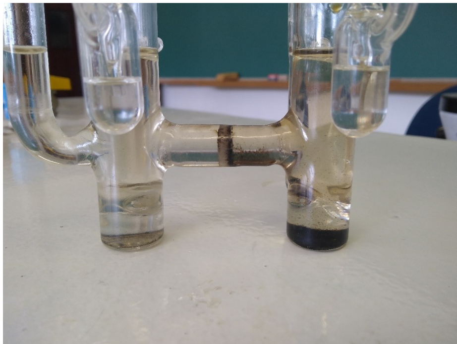
Figura 9 – Imagem da célula eletroquímica contendo os produtos resultantes do processo de esfoliação eletroquímica em meio a DMF.
