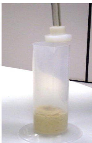
Figura 7. Massa inserida na proveta e pressionada com haste de vidro.
