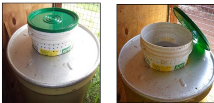
Figura 8 – Balde plástico com orifícios laterais de 5 mm encaixado em uma tampa de metal.
