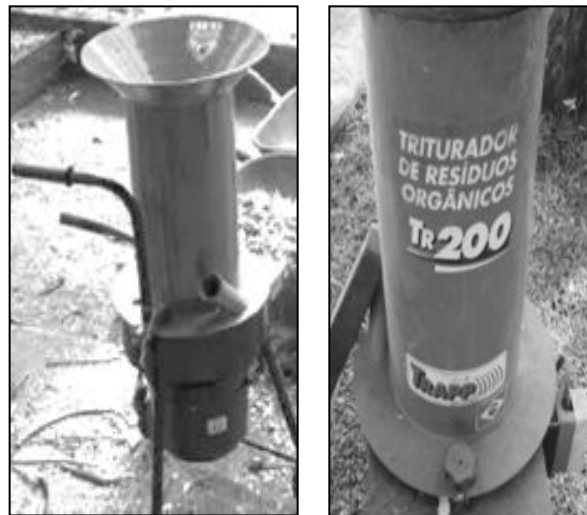
Figura 12 - Equipamento utilizado para trituração de tabaco e papel de cigarros.
