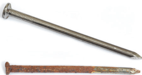
Exemplo de oxidação sofrida por ferro quando exposto à atmosfera e à umidade.
