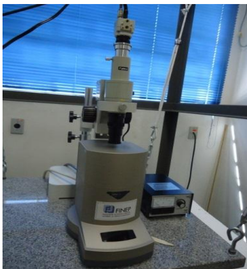
Figura 3.18 - Equipamento utilizado para análise da rugosidade das amostras.
