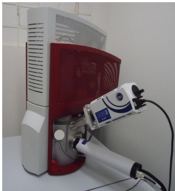
Figura 3.16 - Equipamento de FEG utilizado para microestruturais das amostras.
