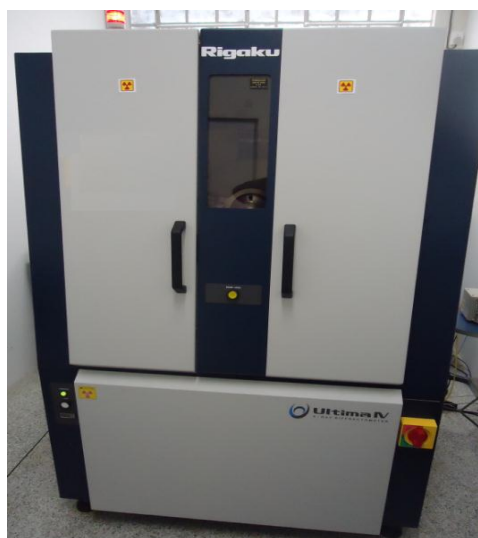
Figura 3.17 - Equipamento utilizado para análise de difração de raios X.
