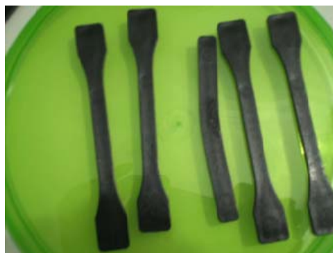
Figura 5.5 - Amostras de PEBD Virgem com 40% de borracha após tratamento com microondas.
