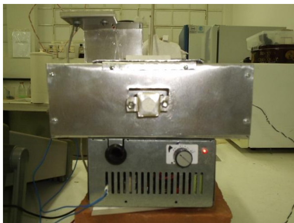
Figura 3.3 – Forno desenvolvido para o aquecimento das amostras (vista frontal).
