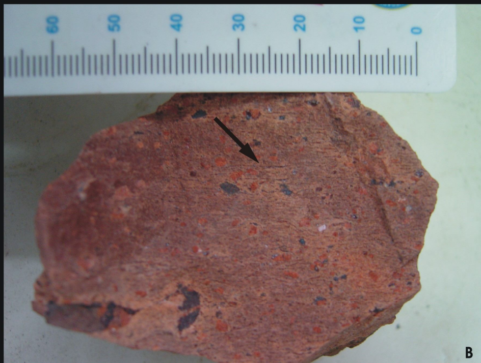
B - Detalhe da amostra de riolito apresentando estrutura fluidal com alinhamento cristais de pórfiros de quartzo e feldspato potássico.
