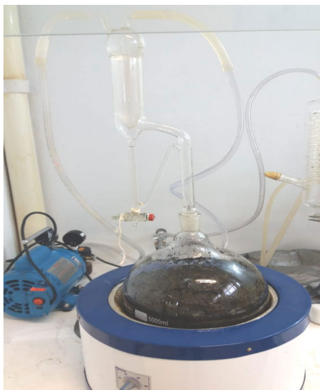
FIGURA 4 - Aparato de Clevenger utilizado na extração de óleo essencial de O. porosa .
