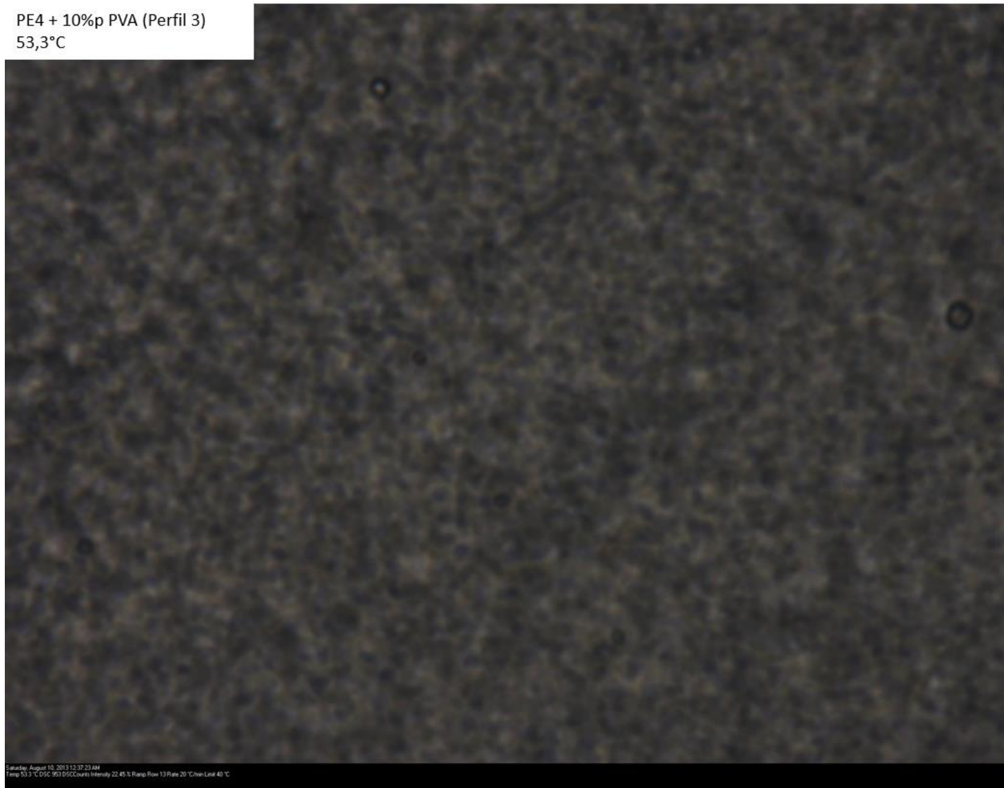
Figura 155 - PE 4 + 10%p de PVA, processados com o perfil de rosca 3. Microscopia óptica acoplada com hot stage, magnificação de 400x, 53,3°C.
