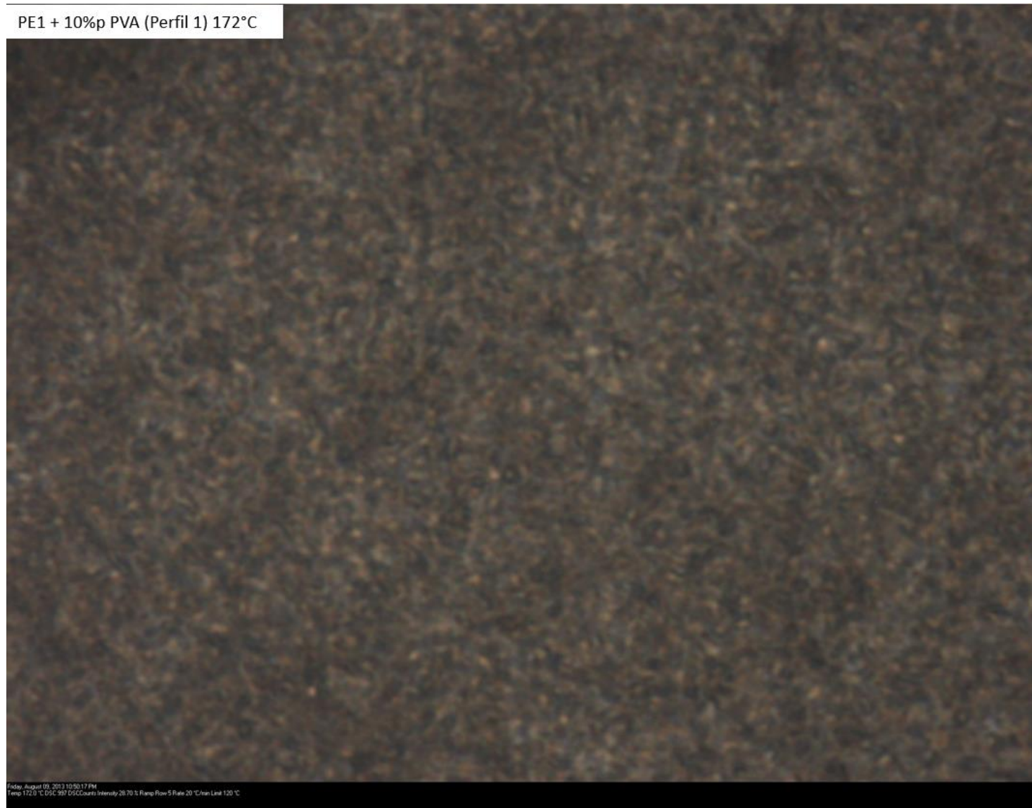
Figura 154 - PE 1 + 10%p de PVA, processados com o perfil de rosca 1. Microscopia óptica acoplada com hot stage, magnificação de 400x, 172°C.
