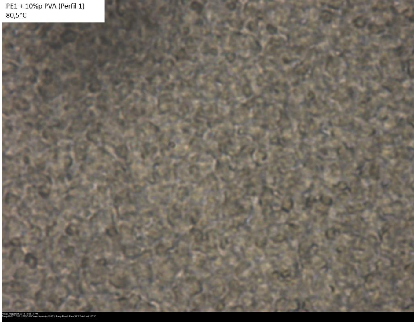
Figura 153 - PE 1 + 10%p de PVA, processados com o perfil de rosca 1. Microscopia óptica acoplada com hot stage, magnificação de 400x, 80,5°C.
