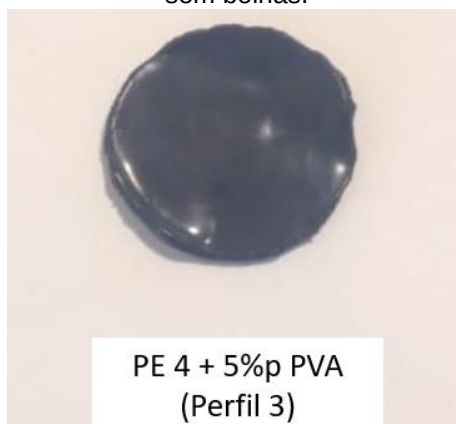
Figura 69 - Amostra PE 4 + 5%p PVA (Perfil 3) após o ensaio de reometria oscilatória. Praticamente sem bolhas.
