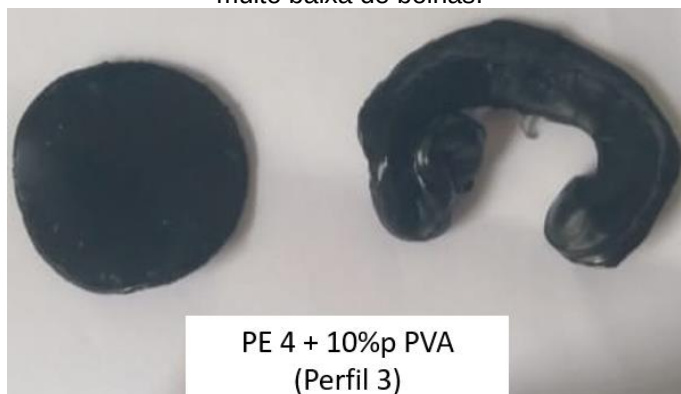
Figura 70 - Amostra PE 4 + 10%p PVA (Perfil 3) após o ensaio de reometria oscilatória. Presença muito baixa de bolhas.
