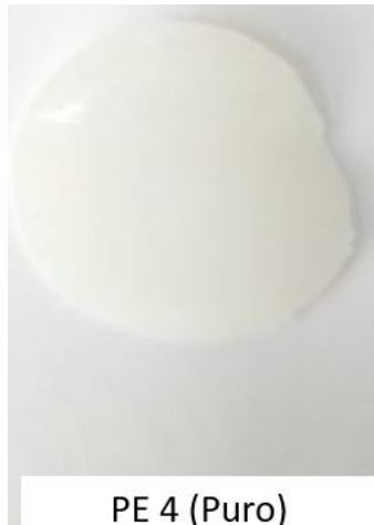
Figura 68 - Amostra PE (Puro), após o ensaio de reometria oscilatória. Total ausência de bolhas.
