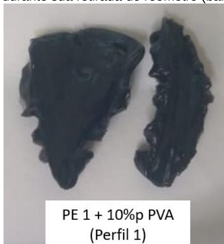
Figura 51 - Amostra PE 1 + 10%p PVA (Perfil 1) após o ensaio de reometria oscilatória. Praticamente sem bolhas. Amostra deformada durante sua retirada do reômetro (baixa resistência do fundido).
