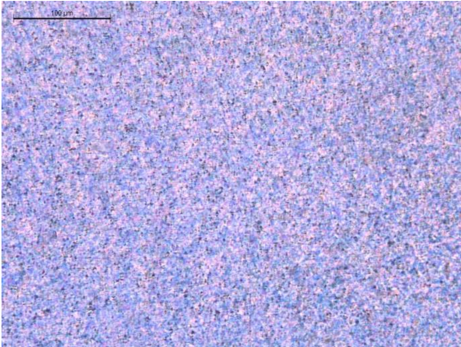
Figura 79 - PE 2 + 5%p de PVA, processado com o perfil de rosca 3. Microscopia óptica, magnificação de 200x. Escala exibe o valor de 100 \mu\text{m} .
