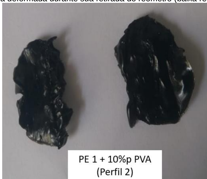
Figura 52 - Amostra PE 1 + 10%p PVA (Perfil 2) após o ensaio de reometria oscilatória. Praticamente sem bolhas. Amostra deformada durante sua retirada do reômetro (baixa resistência do fundido).
