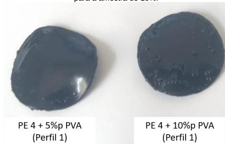
Figura 71 - Amostras PE 4 + 5%p PVA (Perfil 1) e PE 4 + 10%p PVA (Perfil 1) após o ensaio de reometria oscilatória. Presença baixa de bolhas para a amostra de 5%, e uma presença muito intensa para a amostra de 10%.
