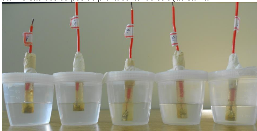
Figura 20: Imagem da imersão dos corpos de prova contendo solução salina.
