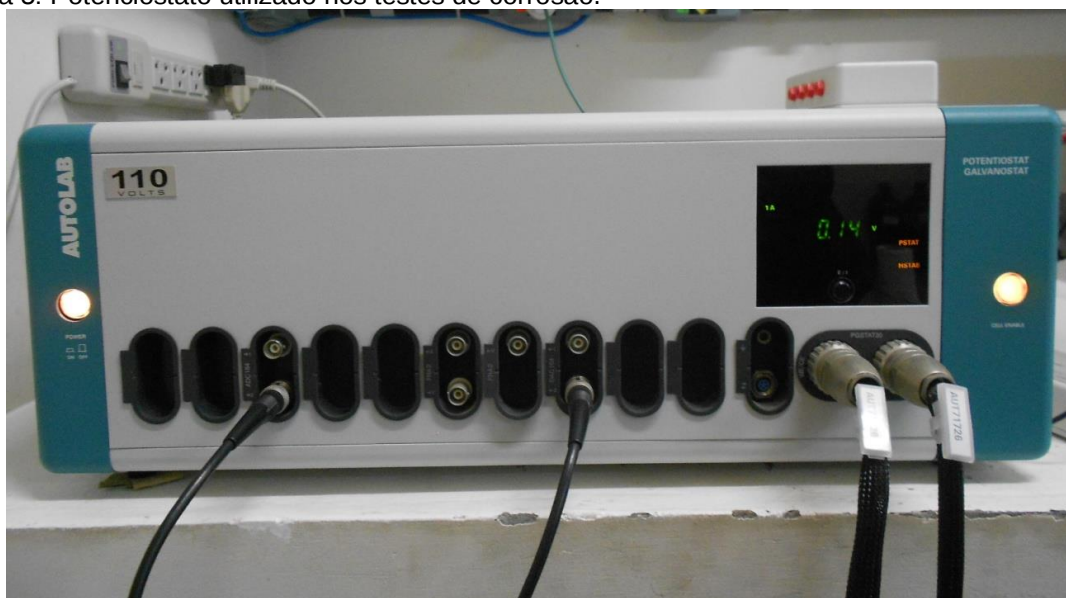
Figura 5: Potenciostato utilizado nos testes de corrosão.
