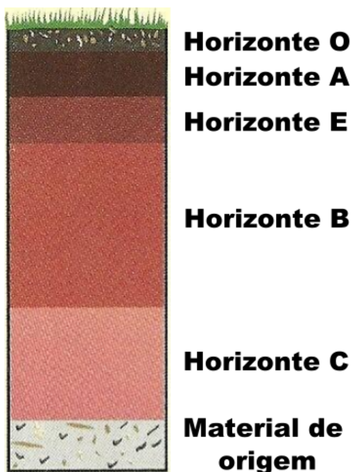
Figura 2.1: Representação esquemática de um perfil de solo hipotético com identificação dos limites referentes aos horizontes O, A, E, B, C e material de origem.
