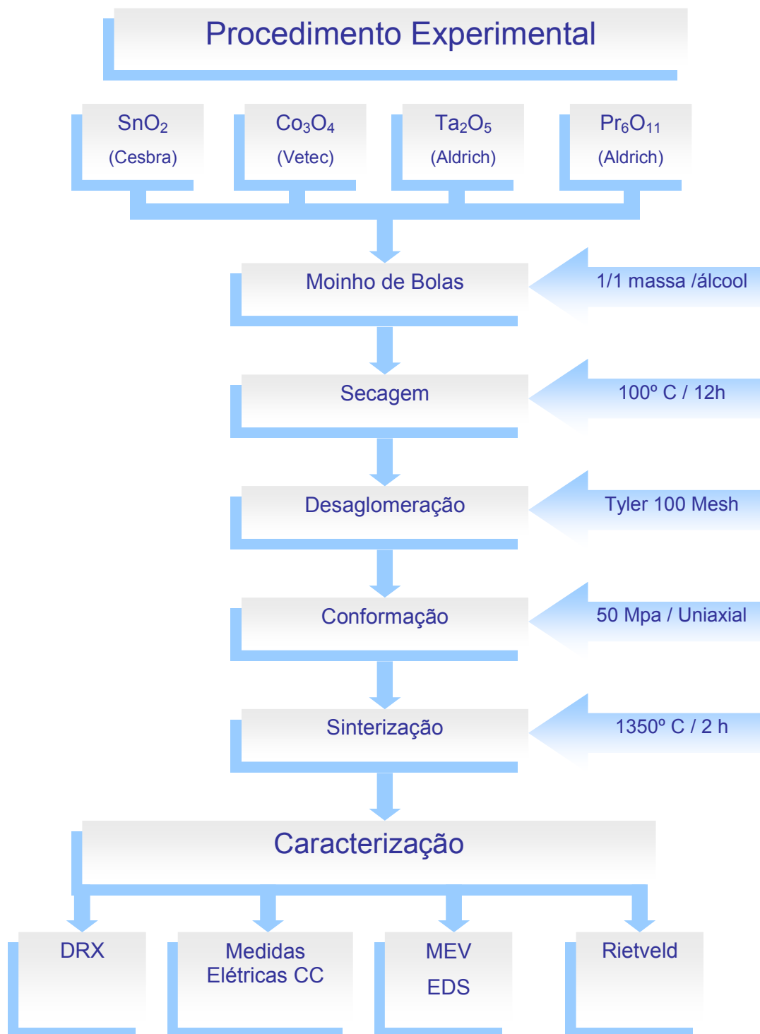
Figura 3.2: Fluxograma do procedimento experimental proposto para obtenção e caracterização das amostras pelo método convencional de mistura de óxidos.
