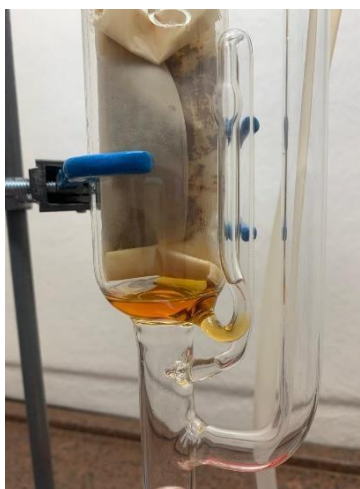
Figura 11 – Extração de compostos apolares com uso do Soxhlet
