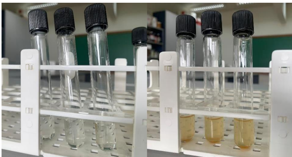
Figura 15 - Amostras da máscara com ativos após centrifugação de 3.000rpm durante 5 minutos, amostra base (a), e amostra com ativo (b)
