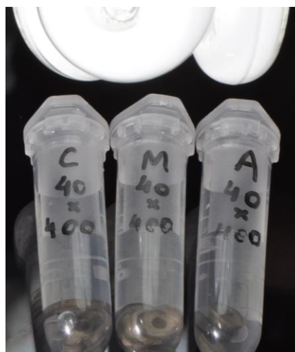
Figura 10 - Espécimes imersos em revelador sob fonte de luz branca direta sobre os espécimes.
