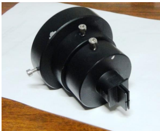
Figura 7 – Uma fotografia mostrando em detalhe a fenda de entrada de bloqueio lateral.
