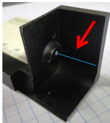
Figura 16 – Fotografia do suporte que fixa e mantém o pino odontológico no alinhamento correto para a mensuração da intensidade de luz espalhada. É dada a indicação da direção do feixe de laser incidente.
