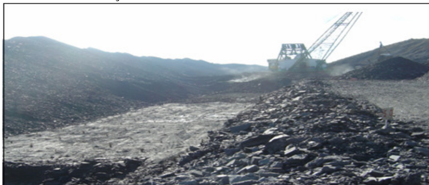
Figura 3 – Foto da mineração a céu aberto das camadas de Xisto, Mina Rio das Pedras – Formação Irati
