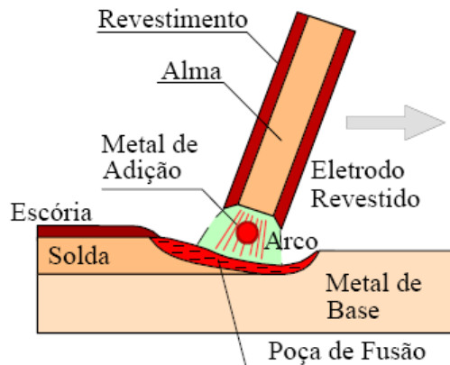
Figura 3.3 — Esquema básico do processo de soldagem com eletrodo revestido.
