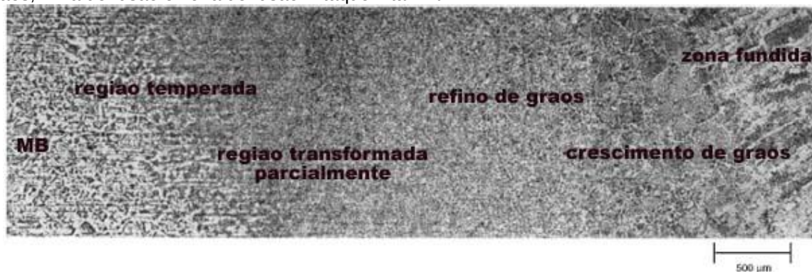
Figura 3.6 — Aço A36, soldagem por eletrodos revestidos, múltiplos passes. Composição micrográfica da Zona Termicamente Afetada (ZTA) mostrando (da esquerda para a direita) metal base, região temperada, região transformada parcialmente, região de refino de grão, região de crescimento de grãos, linha de fusão e zona de fusão. Ataque nital 2%.
