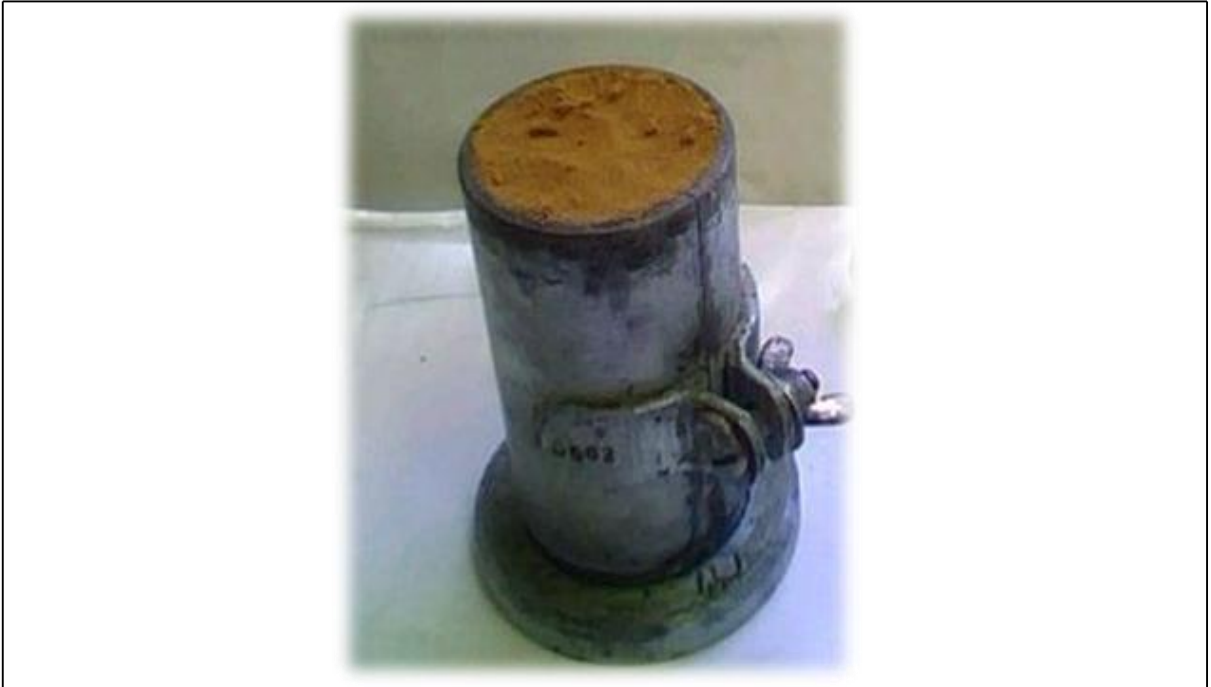
Figura 3.8- Molde metálico empregado para a preparação dos corpos-de-prova
