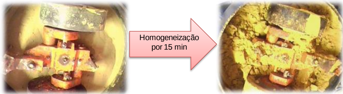
Figura 3.5- Obtenção da areia a verde preparada. Em (a) a adição de bentonita e água na areia base de sílica; em (b) a adsorção de água nas lamelas de bentonita na areia a verde preparada
