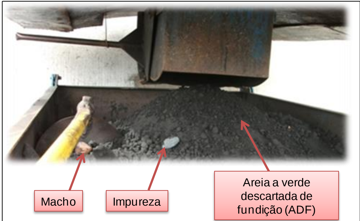
Figura 3.2- Momento do descarte na indústria de fundição e coleta da areia descartada de fundição
