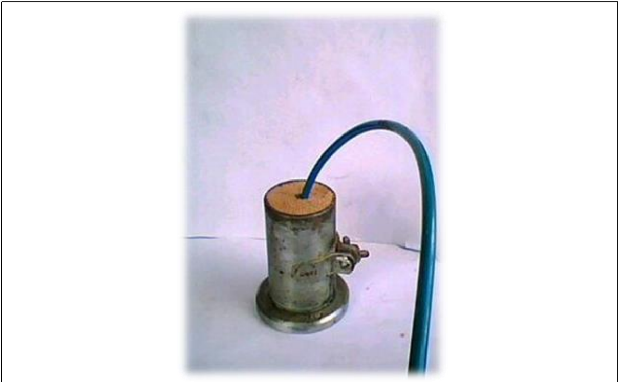
Figura 3.9- Preparação para a gasagem de CO 2 no corpo-de-prova de areia a verde preparada com 8% da solução de silicato de sódio
