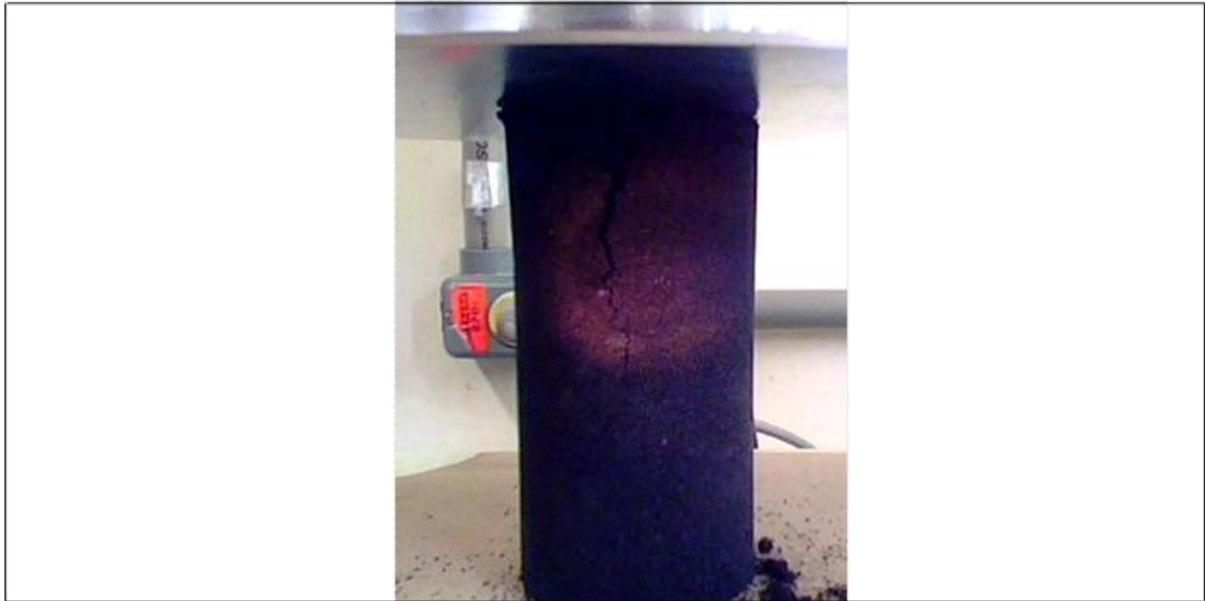
Figura 3.10- Areia descartada de fundição fraturada no ensaio de resistência à compressão
