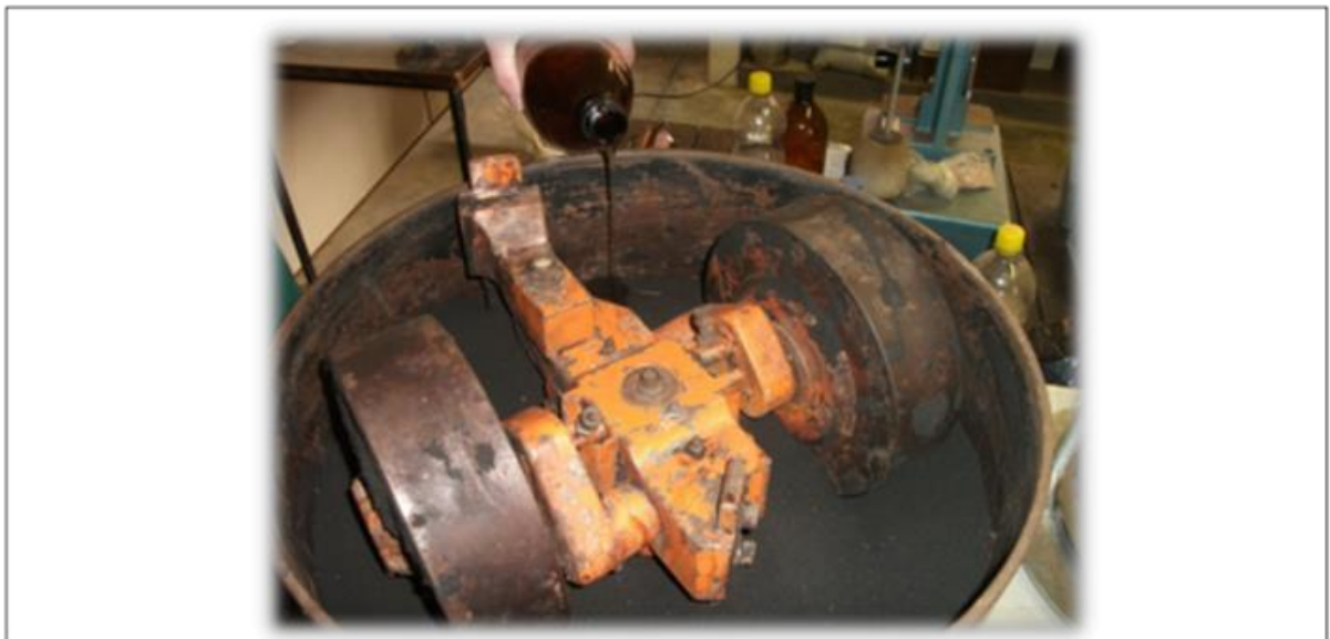
Figura 3.14- Adição da solução de silicato de sódio na ADF no interior do misturador
