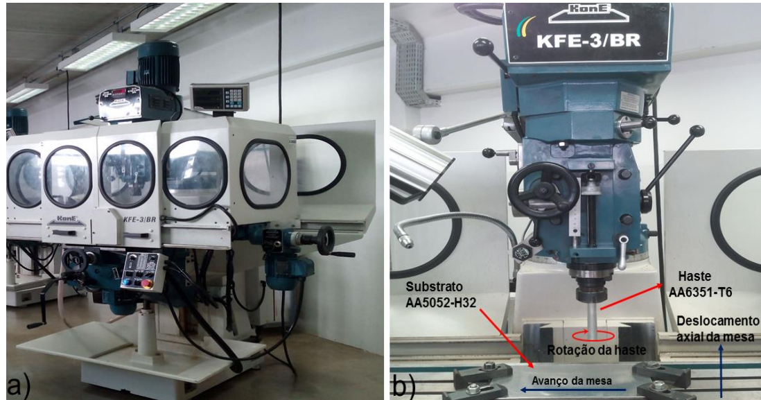
Figura 18-(a) Equipamento utilizado no processamento e (b) configuração operacional utilizada.
