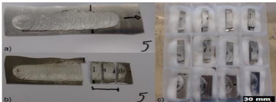
Figura 21-(a) depósito, (b) amostras extraídas dos 30 mm iniciais de cada depósito, (c) amostras de cada condição.
