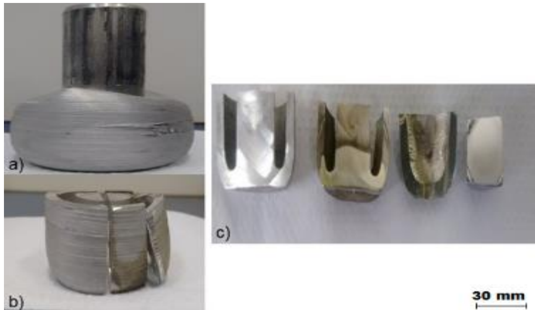
Figura 22- (a) haste, (b) cortes para análise micrográfica e (c) seção longitudinal de cada área analisada.
