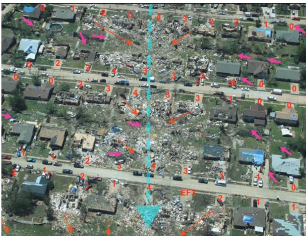
Figura 0.1 - Indicação do rastro de destruição (seta azul) provocado por tornado em 20 de maio de 2013 em Moore, Oklahoma, com variações na EF. As setas vermelhas indicam a convergência para o rastro e os números em vermelho a EF.
