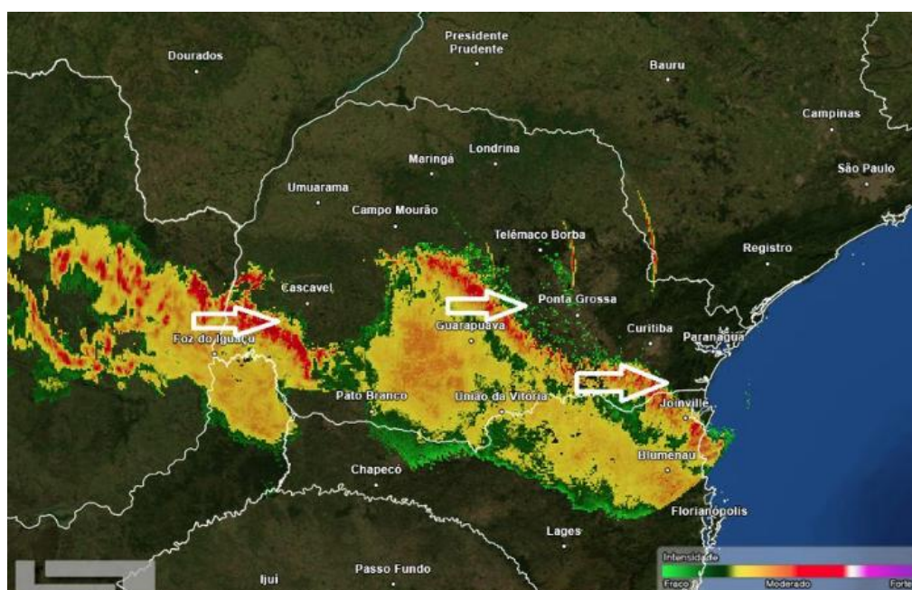
Figura 2.2 - Imagem de Radar Meteorológico Doppler , no qual é possível visualizar uma linha de instabilidade indicada pelas setas, sobre o estado do Paraná e Santa Catarina.
