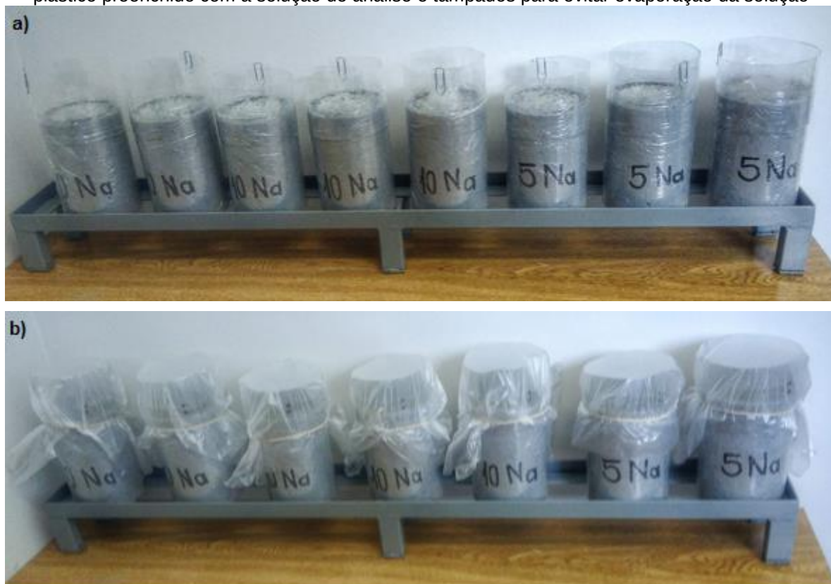
Figura 47 - Amostras do ensaio de difusão não estacionária – ponding: a) Amostras seladas lateralmente, com reservatório plástico, posicionadas em cima do suporte metálico; b) Reservatório plástico preenchido com a solução de análise e tampados para evitar evaporação da solução
