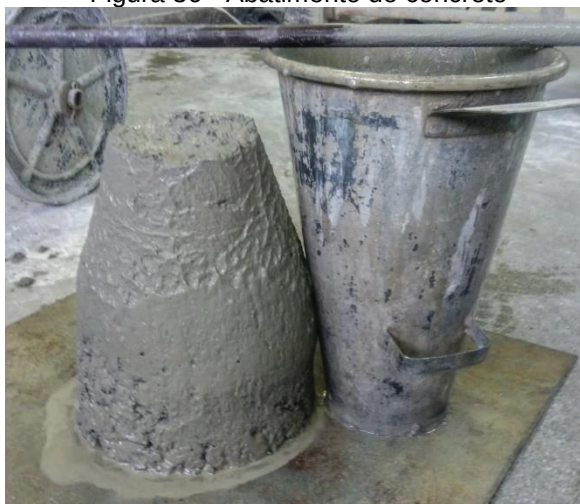
Figura 36 - Abatimento do concreto
