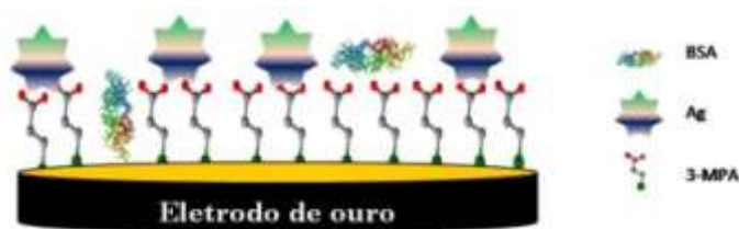
Figura 16 Esquema idealizado da construção do sensor Au/MPA/AG/BSA.
