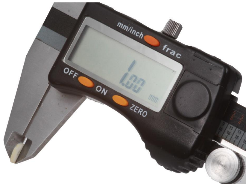
Figura 6 – Verificação da espessura da fatia após corte transversal com paquímetro digital de precisão de 0,01 mm.
