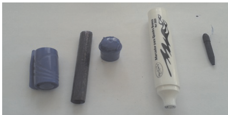
Figura 20: Nesta figura observamos que todas as partes móveis do tubo de pincel atômico foram removidas.
