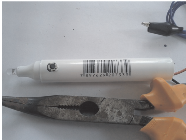
Figura 29: Caneta com o botão de clique e o LED devidamente soldados.
