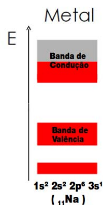
Figura 9: Bandas de energia de um metal. O nível mais alto ocupado, chamado nível de Fermi, fica perto do meio de uma banda. Como existem níveis vazios disponíveis dentro da banda, os elétrons podem ser transferidos para estes níveis, e então o material conduz corrente elétrica.
