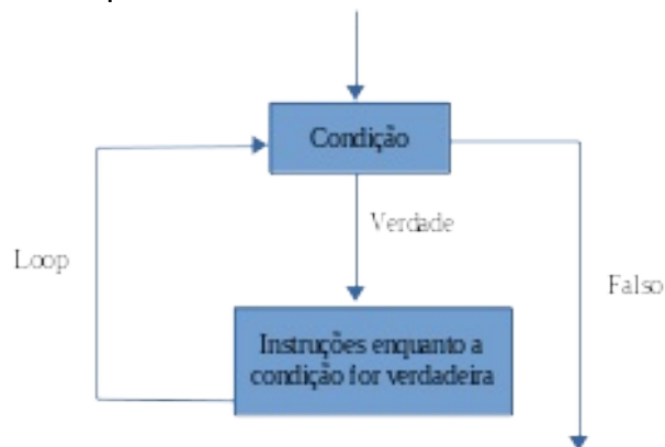
Desenho 1: Estrutura de repetição, isto é, “loop” ou laço. Enquanto a resposta para a condição for verdadeira, executa-se o “loop”.
