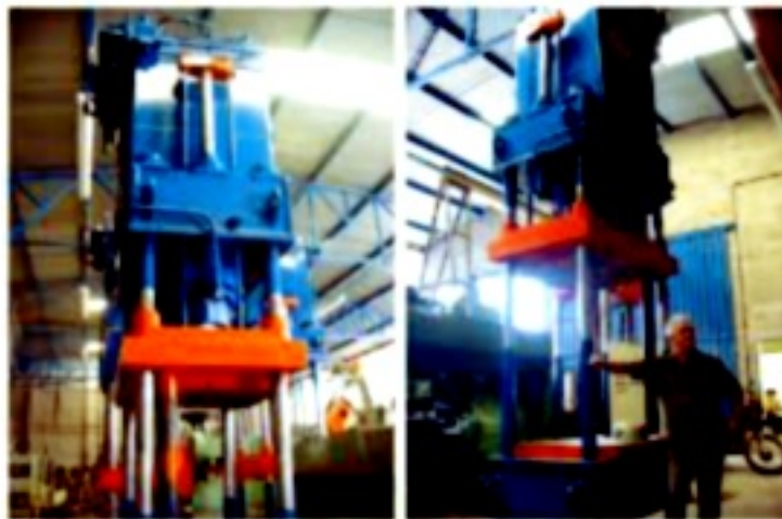
XXX Figura 28: Operador colocando a mão embaixo de uma prensa hidráulica. Retirado e adaptado de http://www.rossimaquinas.com/site/images/stories/virtuemart/product/1420.jpg
