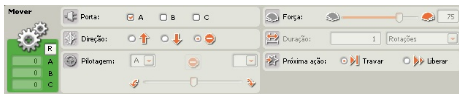
Figura 38: Propriedades que devem ser configuradas no bloco mover quando o resultado do teste lógico for falso.
