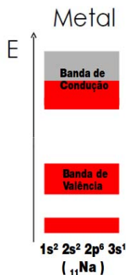
Figura 8: Bandas de energia de um metal. O nível mais alto ocupado, chamado nível de Fermi, fica perto do meio de uma banda. Como existem níveis vazios disponíveis dentro da banda, os elétrons podem ser transferidos para estes níveis, e então o material conduz corrente elétrica.
