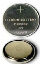
Figura 15: Pilha padrão de 3V utilizada para ligar os LEDS durante a motivação da oficina.
