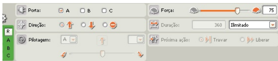
Figura 37: Propriedades que devem ser configuradas no bloco mover quando o resultado do teste lógico for verdadeiro.
