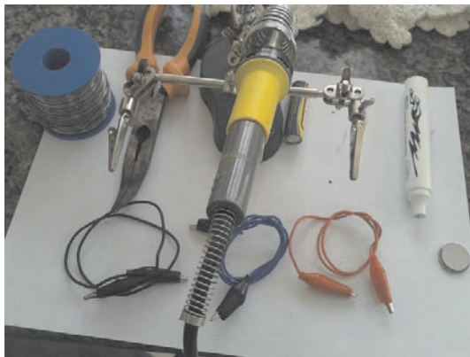
Figura 21: Relação dos itens utilizados nos passos 2, 3 e 4: tubo de pincel atômico vazio, fios para conexão, pilha, alicate, botão para clique, ferro de soldar e estanho.
