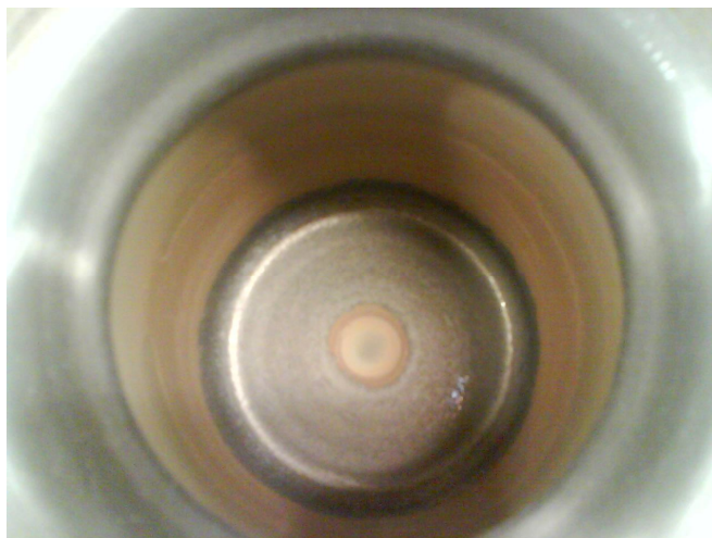
Figura 5.2: Imagem do jarro de moagem do moinho Attritor. Filme de anidrido maleico depositado nas suas laterais.
