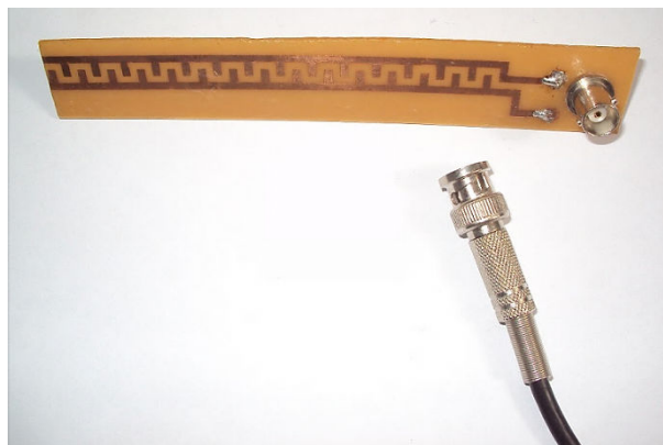
Figura 10 - Primeiro desenho de sensor capacitivo
