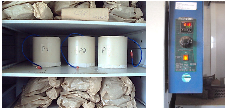
Figura 18 - Amostras no processo de secagem em estufa aerada
