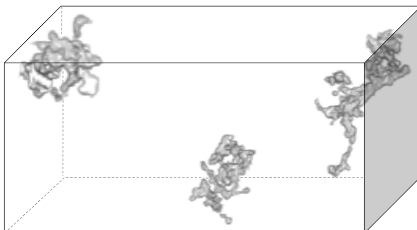
Figura 3.3: Exemplo de configuração de três macroporos detectados a partir de imagens de \mu TC. Cada aglomerado de voxels consecutivos, referentes ao espaço poroso do solo, é identificado como um macroporo independente.
