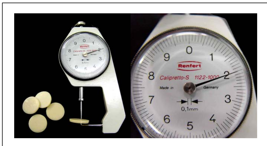
Figura 36- Espessímetro conferindo as espessuras dos corpos-de-prova
