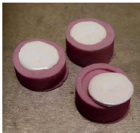
Figura 24- Remoção da cerâmica da matriz
