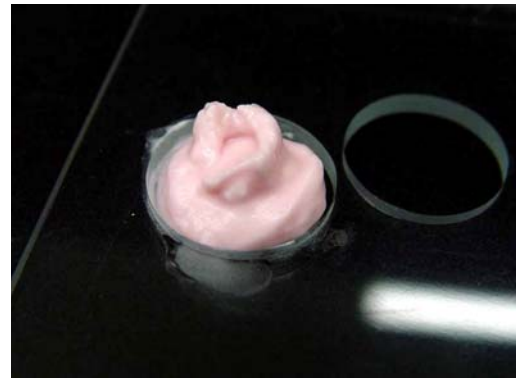
Figura 4 - Condensação da cerâmica na matriz
