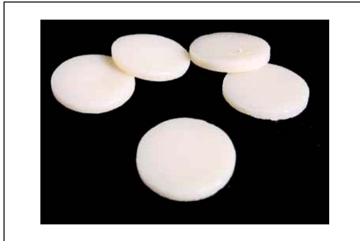
Figura 32 - Corpos-de-prova In-Ceram Spinell concluídos
