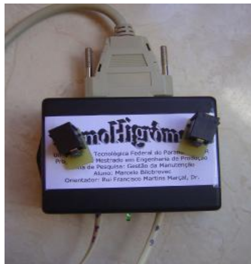
Figura 4.10 - Vista superior da placa de aquisição de dados com os sensores.
