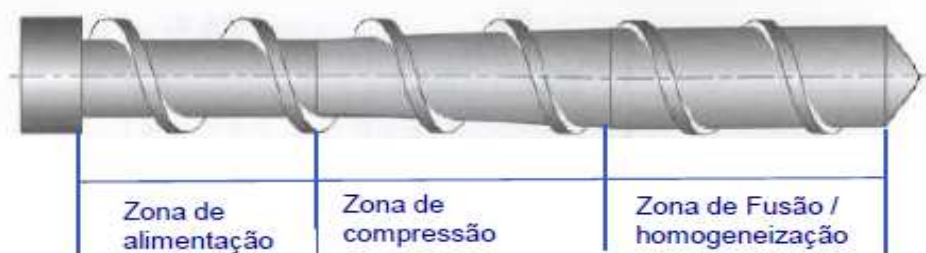
Figura 7. Rosca arquimediana simples com zonas com zona de alimentação, compressão, fusão e homogeneização [31]
