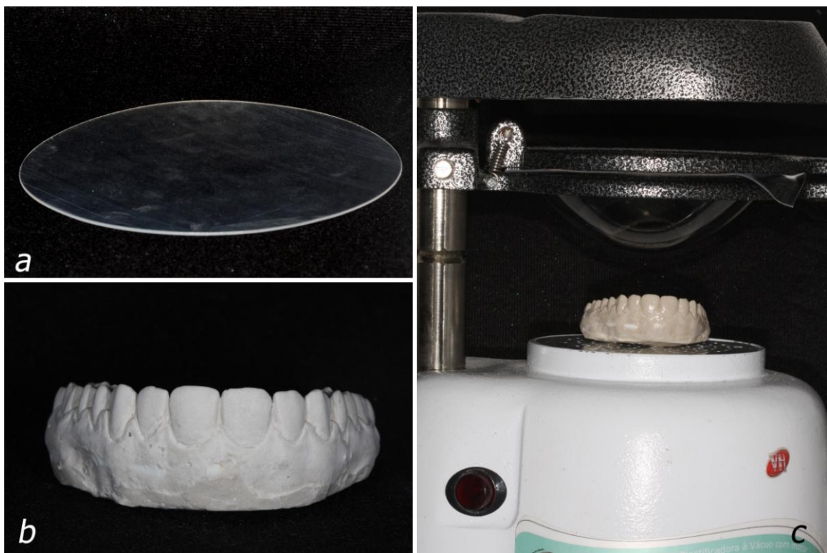
Figura 4 - Seqüência de confecção das moldeiras. Placa de etileno-acetato de vinila com 1 mm de espessura (Whiteness, FGM Produtos Odontológicos, Joinville, SC, Brasil) (a). Modelo de gesso (b). Máquina plastificadora a vácuo (VH, Araraquara, SP, Brasil) no momento da plastificação (c).
