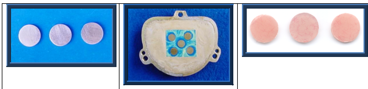
Figura 2: A. Matrizes metálicas. B. Inclusão dos moldes na mufla. C. Corpos-de-prova de resina acrílica termopolimerizável Lucitone 550.
