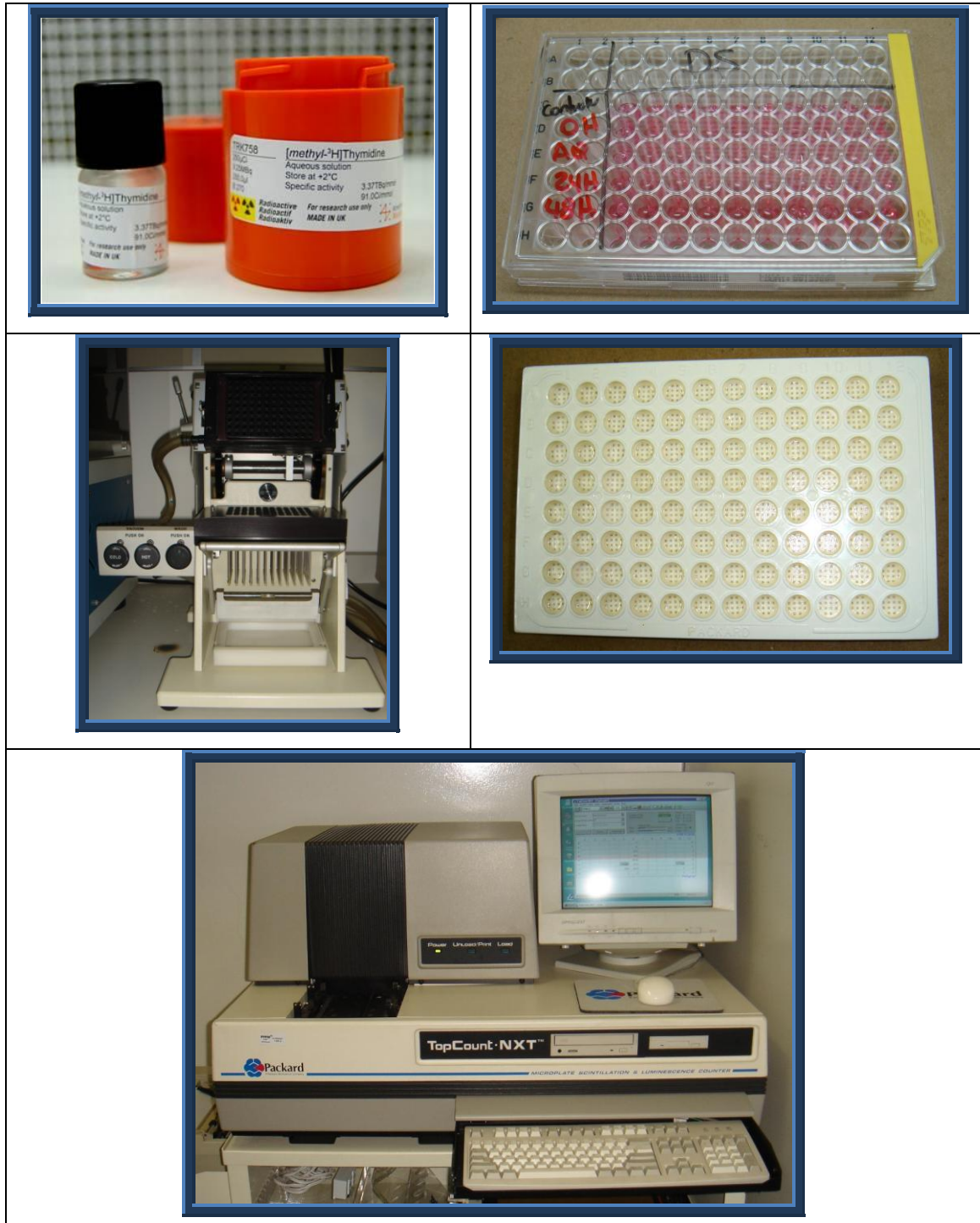
Figura 7: A. ^3\text{H} – timidina. B. Placa de 96 orifícios com a suspensão de células. C. As células marcadas com material radioativo foram aspiradas pelo aparelho Filtermate Harvester. D. Células aderidas na placa 96 orifícios com filtro. E. Leitura do número de células viáveis no contador de cintilação.
