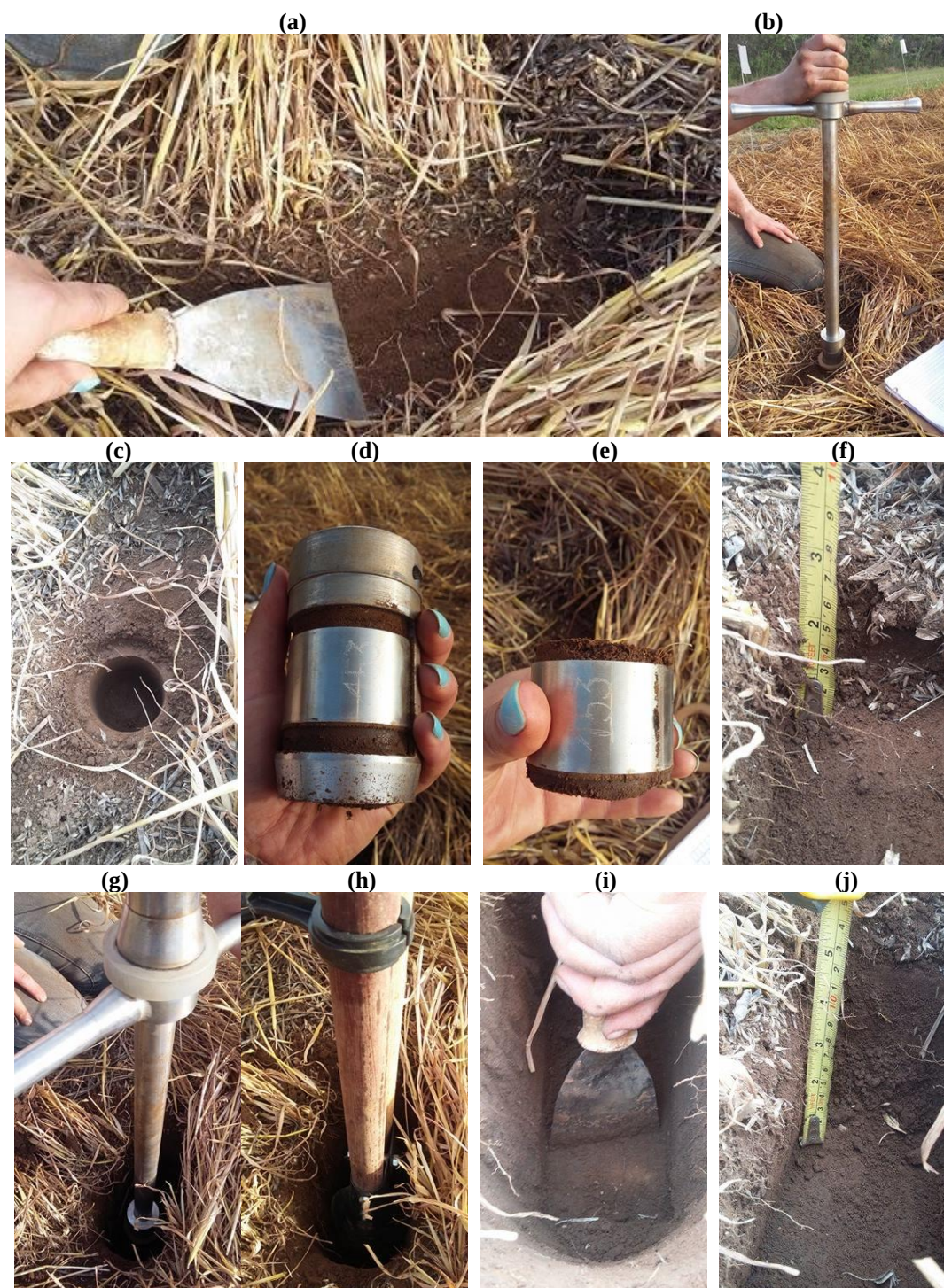
Figura 4.4 – Representação esquemática da coleta de amostras indeformadas de solo em anéis volumétricos: (a) preparo da superfície do solo para coleta das amostras na camada de 0-0,05 m; (b) coleta da amostra com detalhe do amostrador de Uhland adquirido com recursos do projeto; (c) aspecto do solo após a coleta da amostra; (d) detalhe da luva de coleta/proteção do anel volumétrico, na parte inferior do amostrador de Uhland; (e) detalhe do anel volumétrico após retirada da luva de coleta/proteção; (f) abertura de trincheira para coleta de amostras na camada de 0,05-0,10 m, com o auxílio de espátulas; (g) coleta de amostra na profundidade de 0,10-0,50 m; (h, i, j) detalhes da abertura da trincheira para coleta da amostra em profundidades maiores, com o auxílio de cavadeira (h) e espátula (i), com ênfase na medição lateral para determinação da profundidade média da camada (j).
