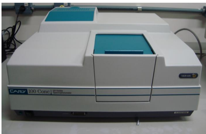
Figura 21 - Espectrofotômetro Cary 100 Varian, utilizado para análise de absorção no UV-Vís.
