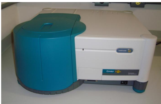
Figura 22 - Fluorímetro Cary Eclipse Varian utilizado para análise de fluorescência.
