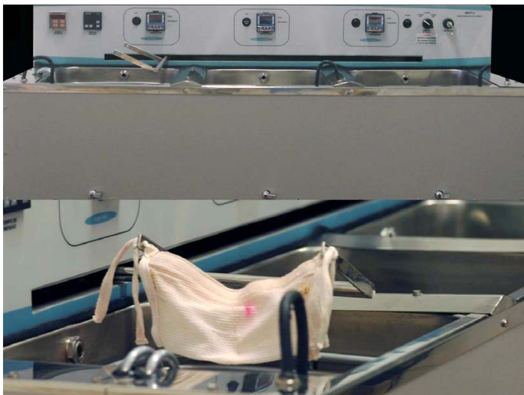
Figura 10 – Máquina de termociclagem e procedimento de estresse térmico
