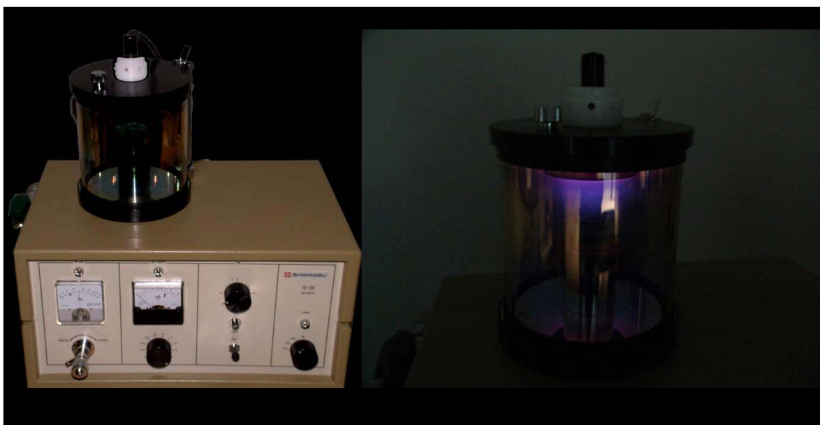
Figura 23 – Aparelho e procedimento de metalização áurica dos espécimes
