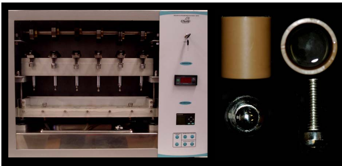
Figura 11 – Máquina de carga cíclica oclusal, cilindro de PVC com resina epóxica para fixação das raízes dos dentes, e ponta aplicadora da força
