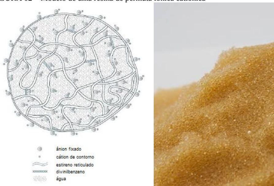
FIGURA 02 – Modelo de uma resina de permuta iônica catiônica
