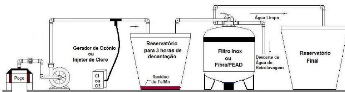
FIGURA 07 – Esquema de um sistema de oxidação química e filtração pressurizada
