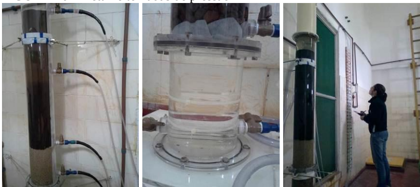
FIGURA 26 – Detalhe tomadas de pressão
