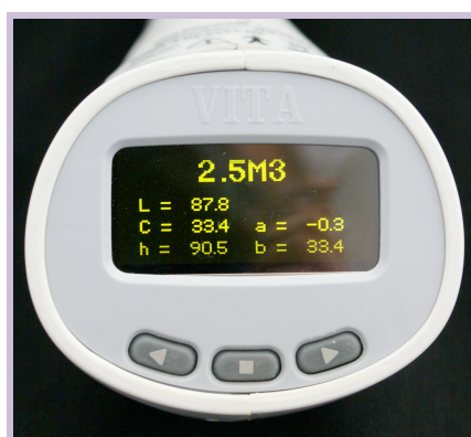
Figura 5 - O espectrofotômetro Easy Shade (Vita Zahnfabrik, Bad Säckingen, Alemanha), indicando os parâmetros de cor: L^* , a^* e b^* , onde L^* indica luminosidade, a^* variação de cor na direção verde-vermelho e b^* variação de cor na direção amarelo-azul
