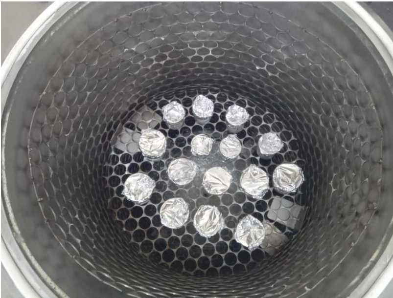
Figura 12 – Amostras em autoclave para realização do ensaio de degradação hidrotermal.
