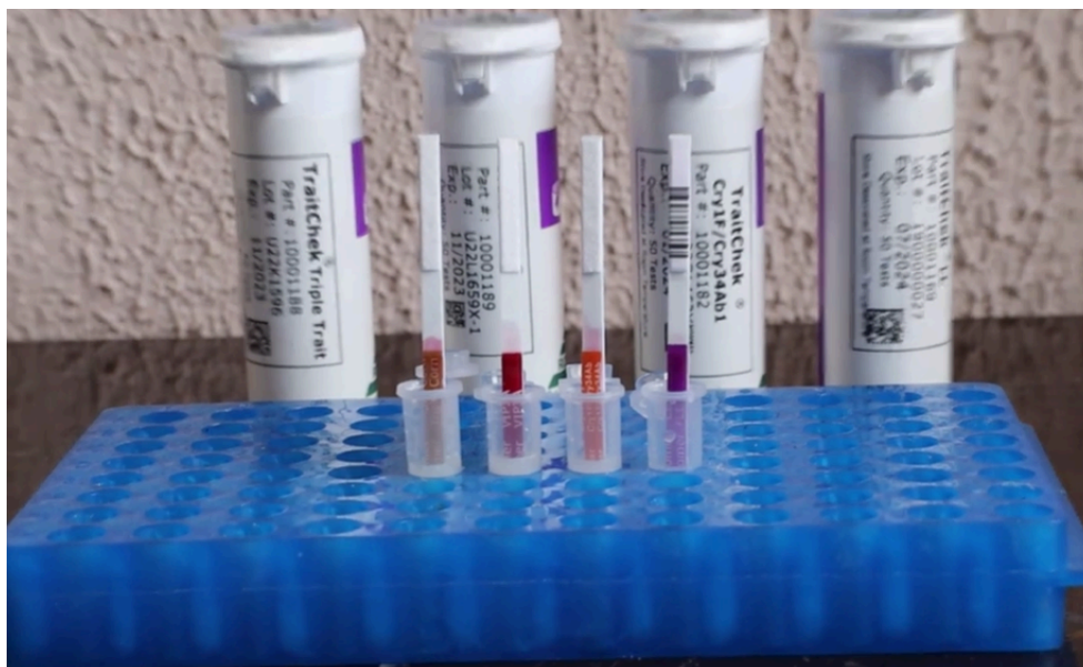
FIGURA 18 - Teste de imunocromatografia em tiras para detectar proteínas transgênicas no milho
