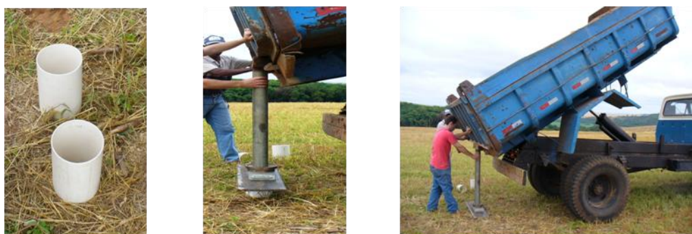
Figura 2. Coleta de amostras indeformadas realizadas na área experimental, com o uso de caçamba hidráulica.
