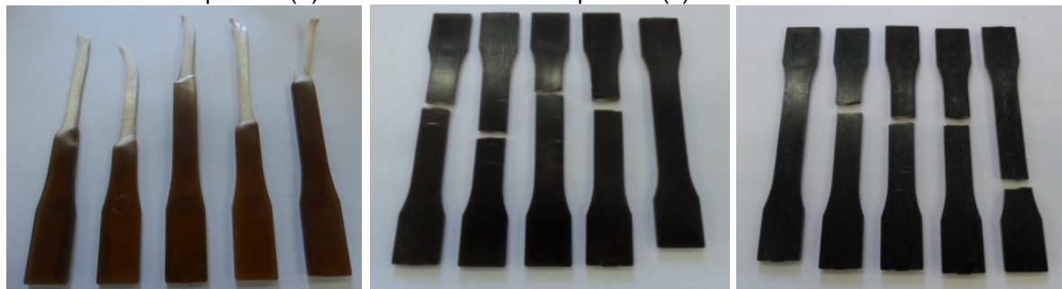
Figura 5.12 - Aparência dos corpos de prova após ensaio de tração. Amostras com 1% pectina (a); amostras com 3% pectina (b) e amostras com 5% de pectina (c).
