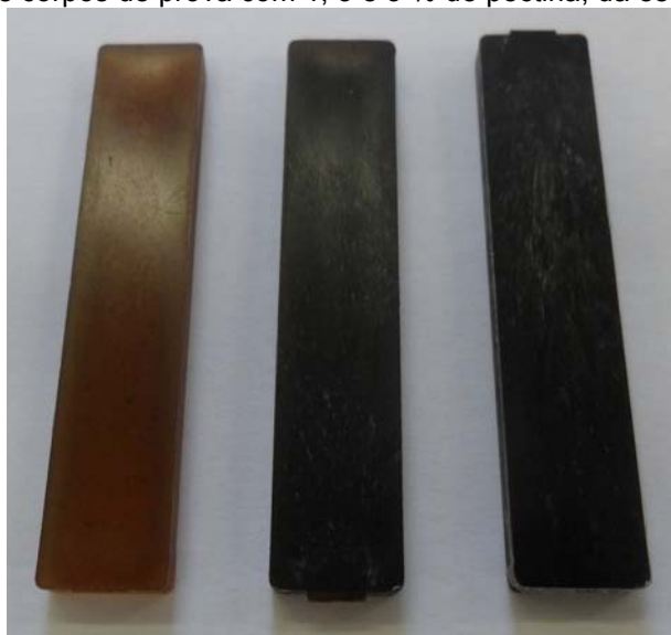
Figura 5.18 - Imagem dos corpos de prova com 1, 3 e 5 % de pectina, da esquerda para a direita.
