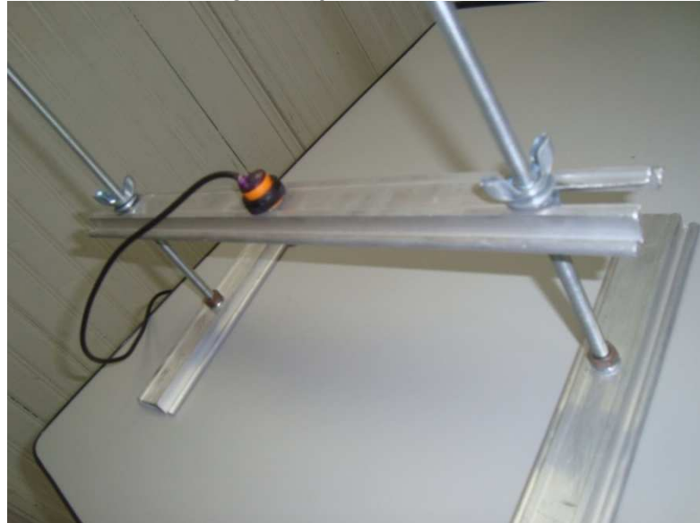
Figura 36 - Base de Altura Regulável para o Sensor
