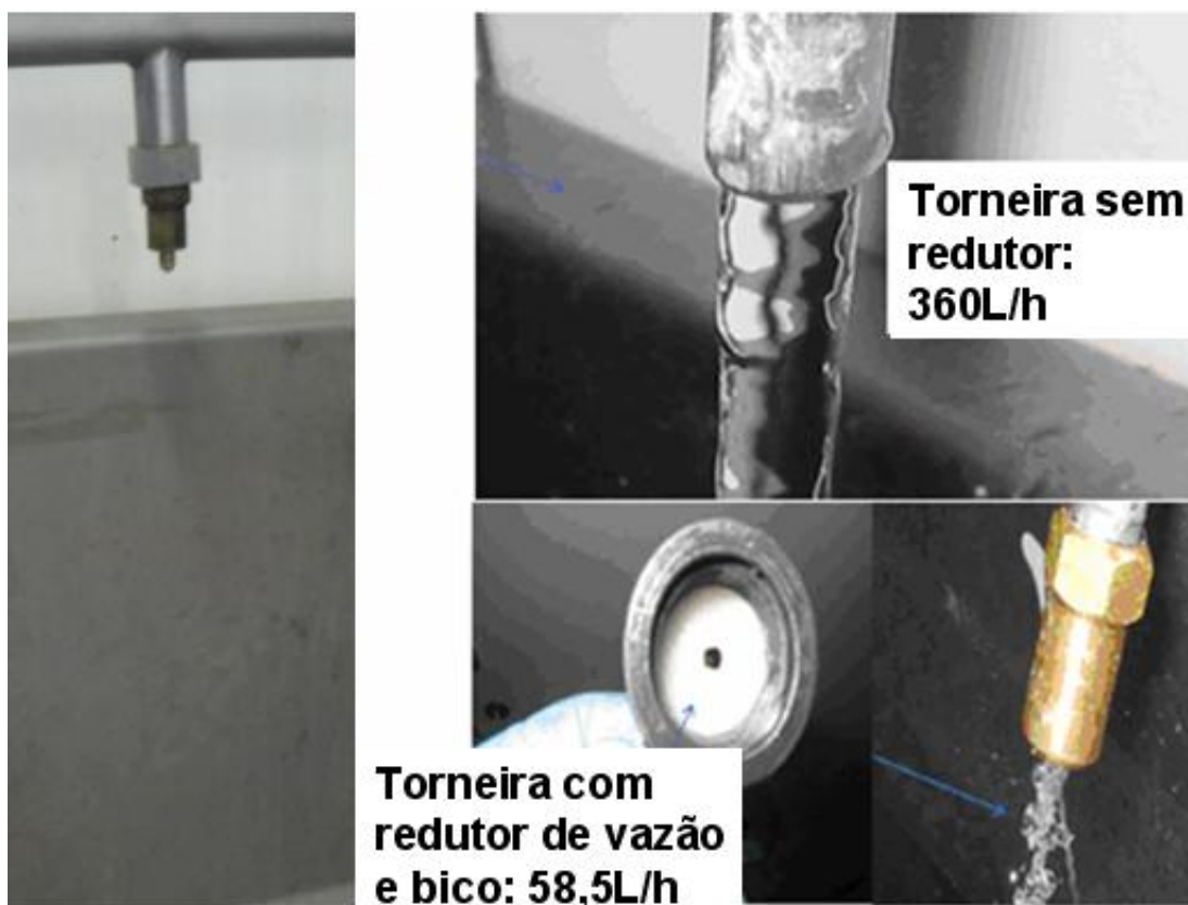
Figura 13 – Fotos das válvulas sem redutor de vazão e com redutor
