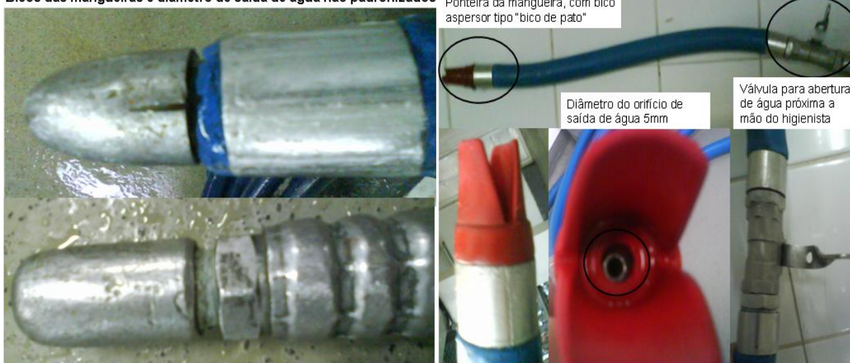
Figura 11 – Bicos das mangueiras utilizadas durante o processo de higienização e mangueiras com ponteiros propostas para a redução do consumo de água.
