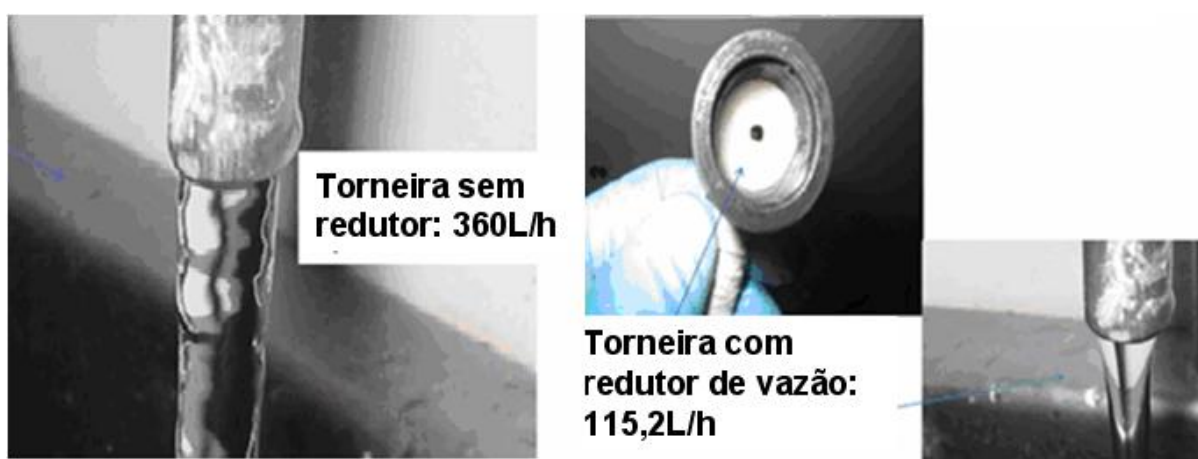
Figura 12 – Fotos das torneiras sem e com o redutor de vazão
