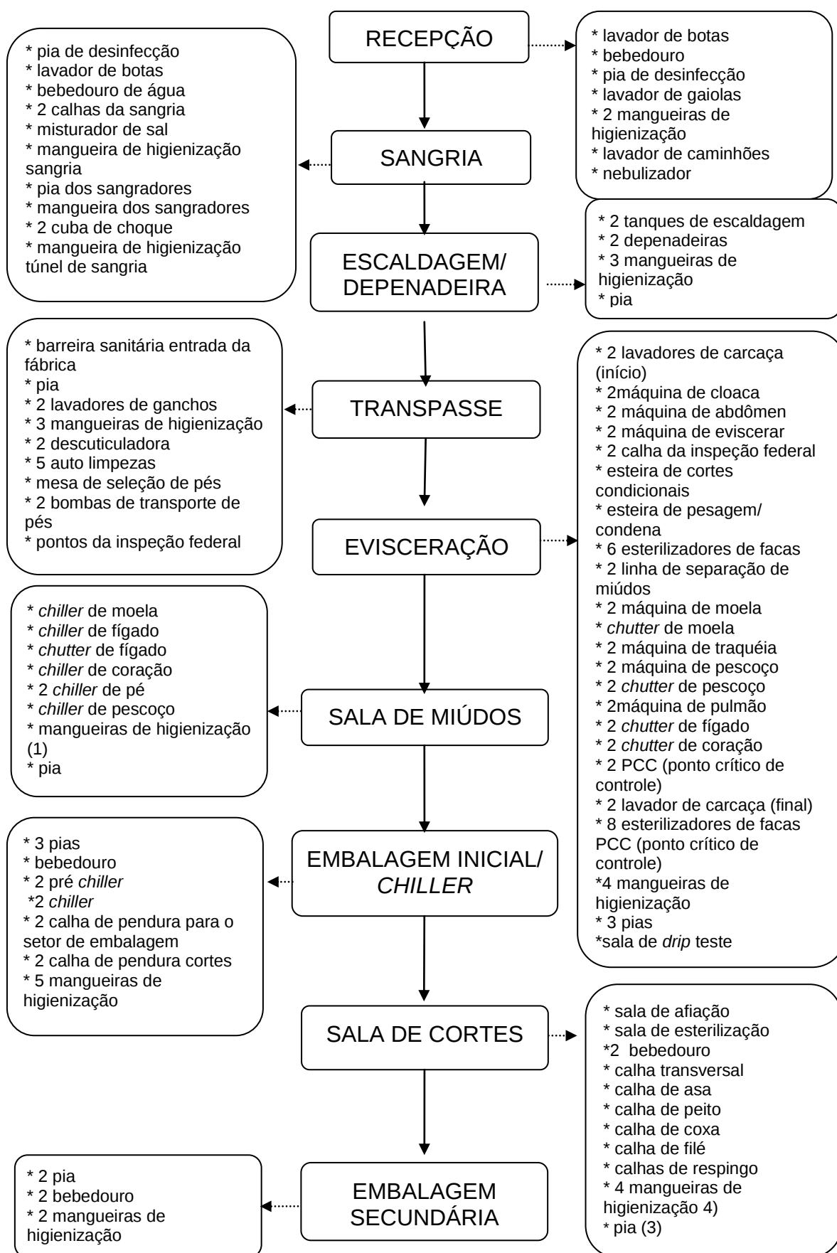
Figura 7 - Fluxograma do processo e pontos de consumo de água potável
